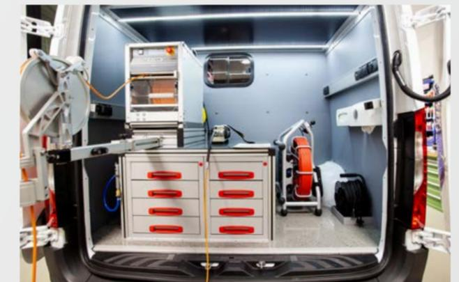
Quereinbau mit 300m Hauptkanalanlage und Schiebeanlage
